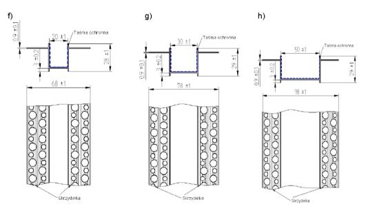
Fig. 4. Beads BP11 H1(a), BP11 H2 (b), BP11 H3 (c), BP11 H3N (d), BP11 H5 (e), BP11 H2 R (f), BP11 H3 R (g), BP11 H5 R (h)
